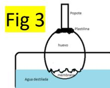
Colocar el huevo con la membrana expuesta hacia abajo dentro del vaso o caja petri previamente llenado con agua destilada. Es importante que la membrana esté sumergida en el agua. (FIG 3)
