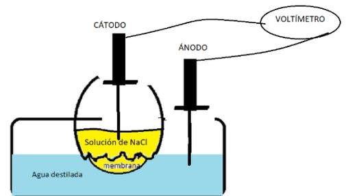
Ponga en el interior del huevo una disolución concentrada de Cloruro de Sodio (NaCl) y ponga agua destilada en el exterior del huevo.
