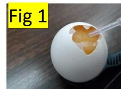
Perforar el vértice opuesto completamente de manera que sea posible introducir un popote al interior del huevo. Introducir, por el orificio formado, el popote en el huevo a una profundidad tal que esté en contacto con la clara, sin romper la yema.
