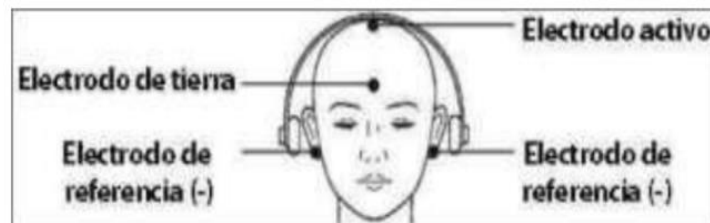
Figura 1. Localización típica de los electrodos para registrar potenciales evocados
